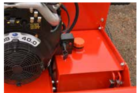
Tilava 32 l polttoainesäiliö mahdollistaa klapikoneen tauottoman käytön. Tasonäytöstä voi tarkistaa polttoaineen määrän.
