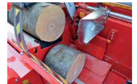
Ohjauslevyjen avulla lyhyimmätkin puut putoavat hallitusti halkaisukouruun.
