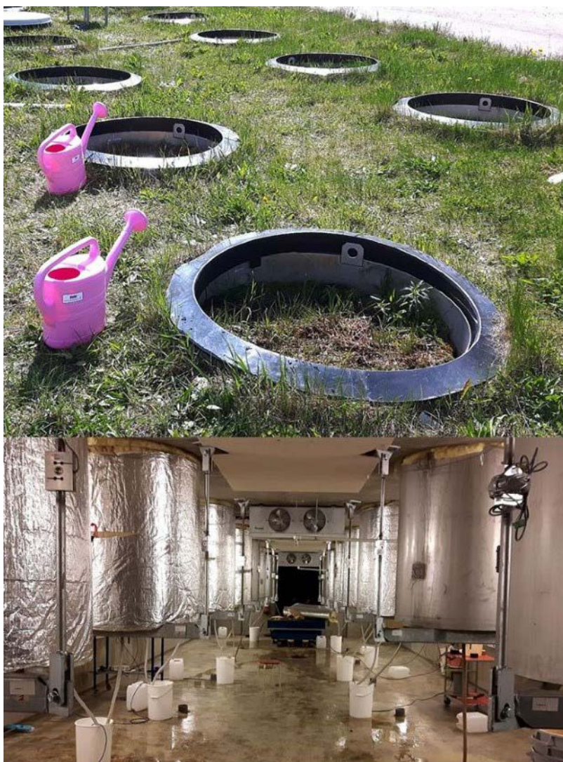
Tilavuudeltaan 2 m 3 lysimetrit kuvattuna maan päältä (ylempi kuva) ja maan alapuolella tutkimushallissa. Keväällä ja kesällä 2016 lysimetrit kasteltiin kastelukannuista keinotekoisella hulevedellä. Kuva: Marjo Valtanen ja Kirsi Kuoppamäki
