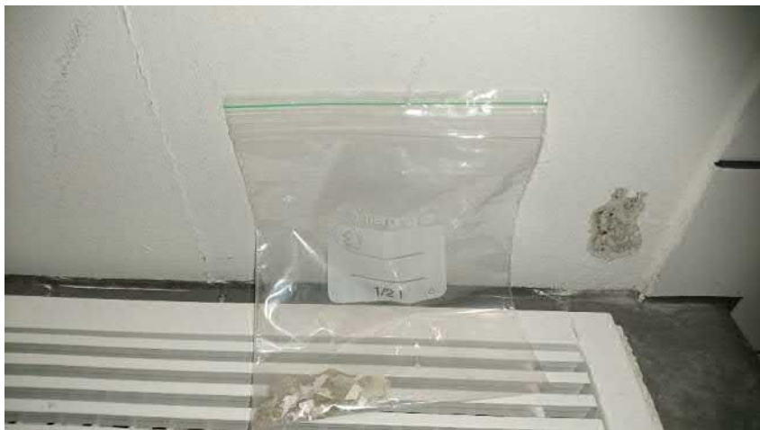
Näyte 8. Sisäseinätasoite harmaa ja ruskea /maali. (uima-allasosasto) Ei sisällä asbestia.
