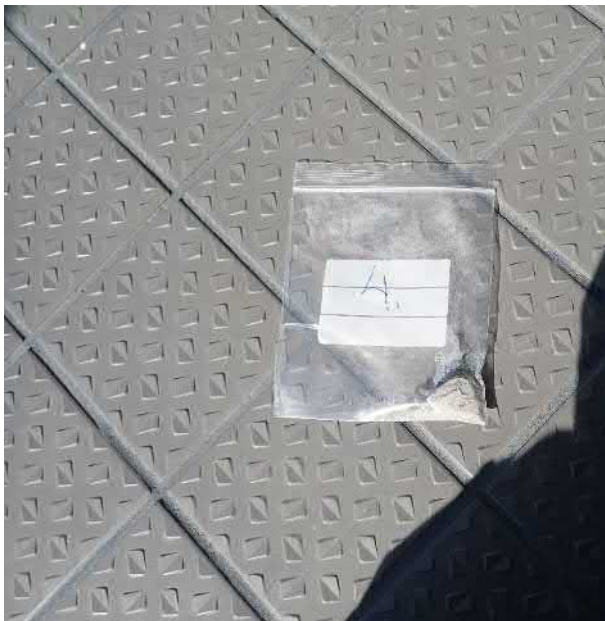
Näyte 4. Harmaa lattialaatta, sauma, laastit. Ei sisällä asbestia.
