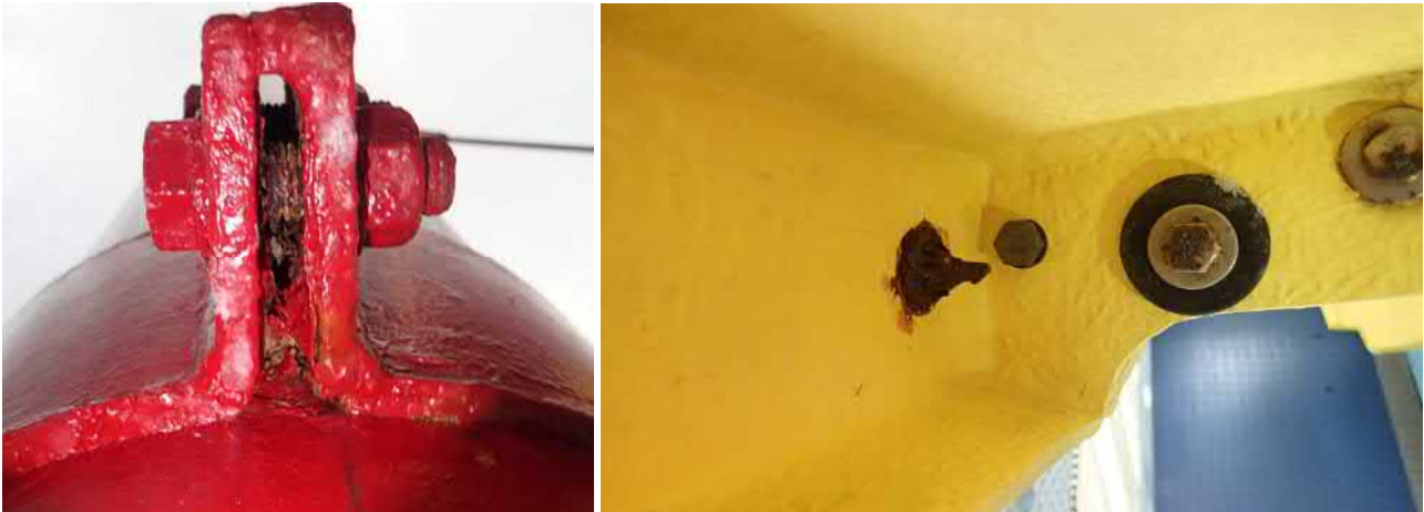
Kuva 1 ja 2. Kuumasinkittyjä kiinnikkeitä liukumäessä
