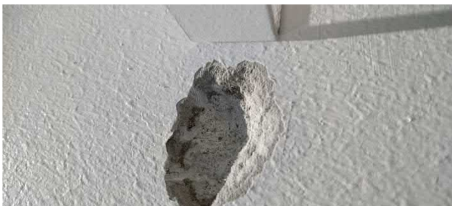
Näyte 10. Sisäseinätasoite harmaa/maalit. (kellarin käytävä). Ei sisällä asbestia.
