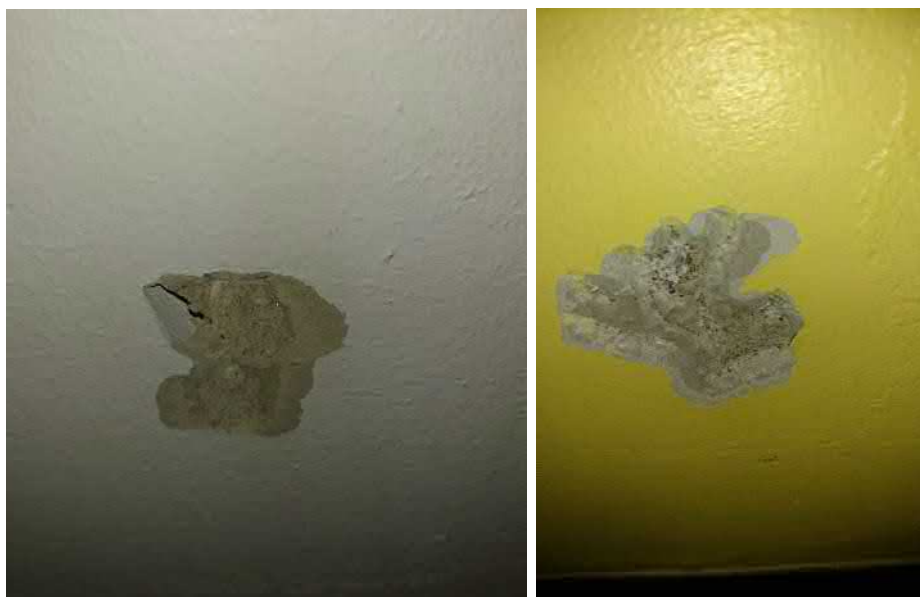
Näyte 10. Sisäseinätasoite harmaa/maalit. (kellarin käytävä). Ei sisällä asbestia.
